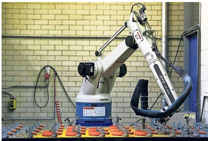
Een robot snijdt rubberen afdichtdoppen voor bouwlampen.
