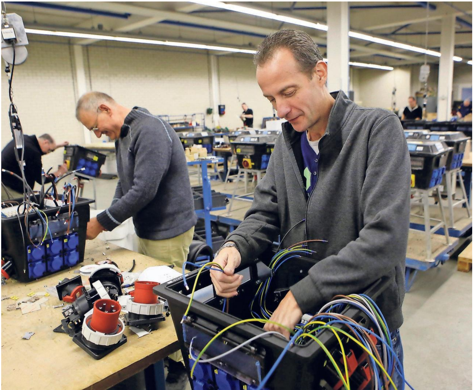
Arjan Veenendaal (r) bundelt een wirwar aan stroomdraden in de zwarte rubberen kast.
